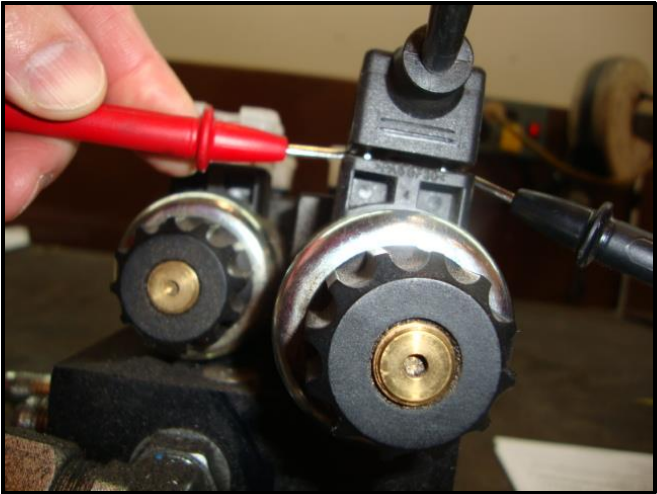
Fig. 8.4 Checking Din Plug Voltage
